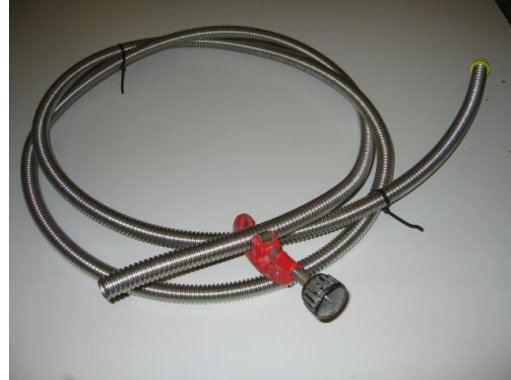
Overskæring udføres med rørskærer. PAS PÅ skarpe kanter efter overskæring.
