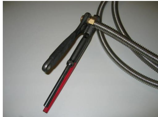
Spænd brystnippen sammen med omløber uden pakning
